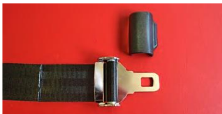
Fig. 7 Fate ripassare la cintura al di sopra del fermo attraverso la linguetta di aggancio.
