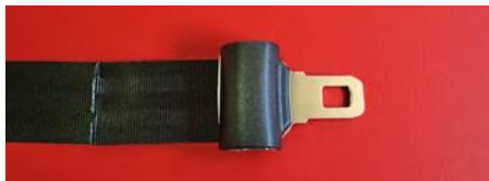
Fig. 8 Posizionate, premete e fate scattare in posizione la copertura in plastica dall'alto sulla linguetta di aggancio.
