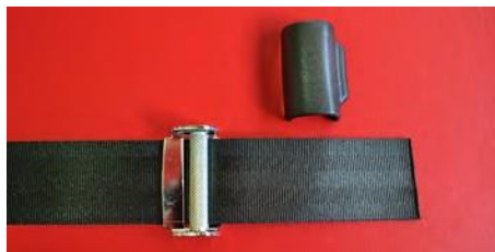
Fig. 6 Fate passare la cintura sotto il fermo.
