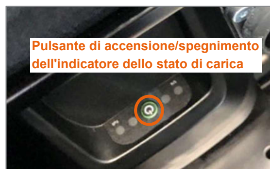
Figura 31: Pulsante di accensione/spegnimento dell'indicatore dello stato di carica
