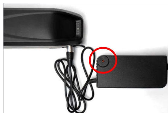
Figura 36: Caricamento batteria in corso - il LED è rosso
