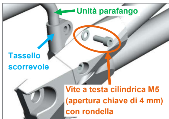
Figura 83: Vite a testa cilindrica M5 per il fissaggio dell'unità parafango nel tassello scorrevole
