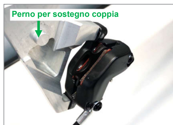
Figura 67: Estremità di scarico a sinistra per mozzo Rohloff
