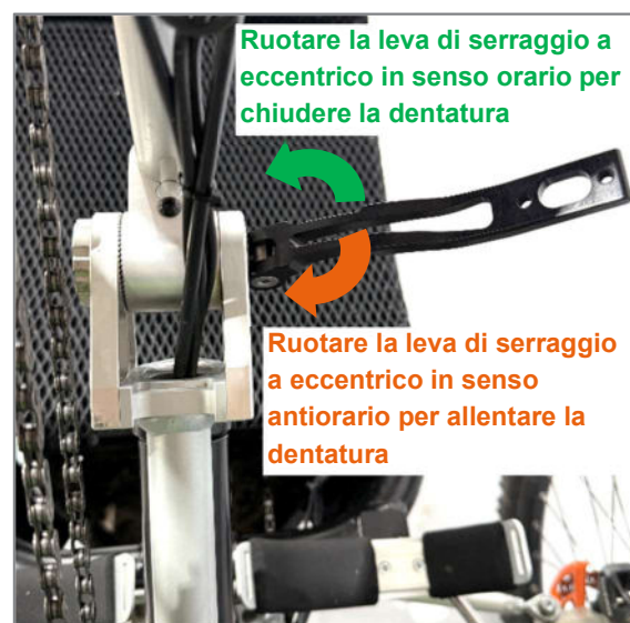
Figura 4: Allentamento e chiusura della dentatura mediante la leva di serraggio a eccentrico
