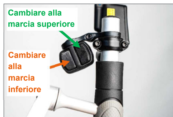
Figura 13: Pulsanti per passare ad una marcia superiore o inferiore del cambio SRAM
