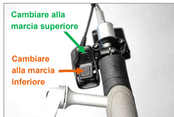
Figura 19: Pulsanti per passare ad una marcia superiore o inferiore del cambio Rohloff
