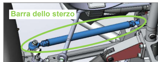
Figura 75: Regolazione della traccia mediante le barre inferiori dello sterzo
