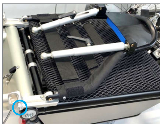
Figura 53: Schienale ripiegato e Quick Pin reinseriti
