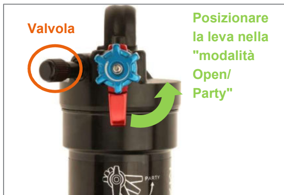
Figura 40: Posizionamento della leva nella "modalità Open/Party" per l'ammortizzatore Manitou Mara Inline
