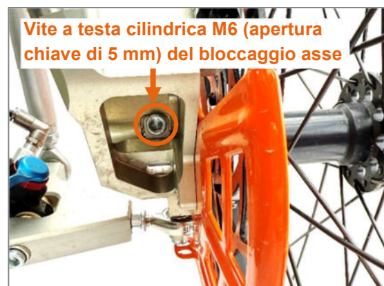
Figura 58: Bloccaggio asse sul portaruota (vista ruota destra)
