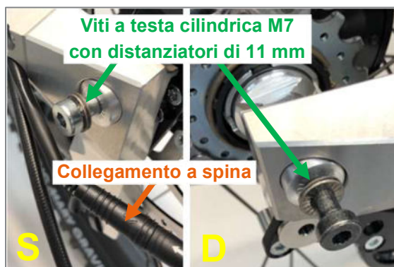
Figura 63: Viti a testa cilindrica a destra e a sinistra, ruota motrice con mozzo Rohloff
