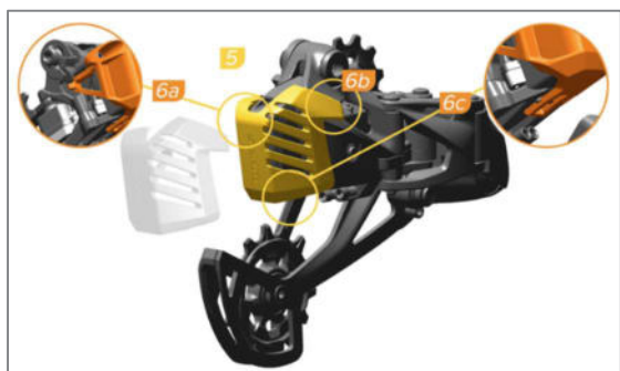
Figura 15: Rimuovere la batteria per la ricarica
