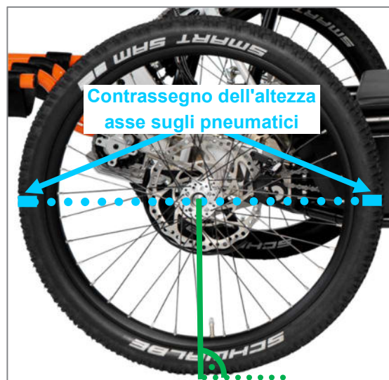
Figura 71: Contrassegno dell'altezza asse anteriormente e posteriormente su entrambi gli pneumatici delle ruote
