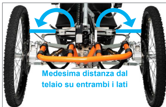
Figura 73: Distanza posteriore dal telaio
