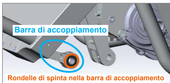
Figura 87: Barra di accoppiamento con rondelle di spinta estratta dal rinvio del braccio oscillante
