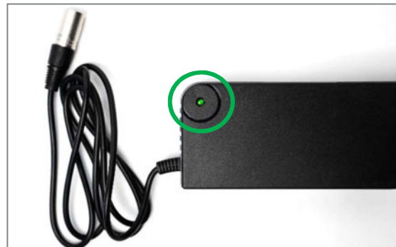
Figura 35: Caricabatteria pronto per la ricarica - il LED è verde intenso
