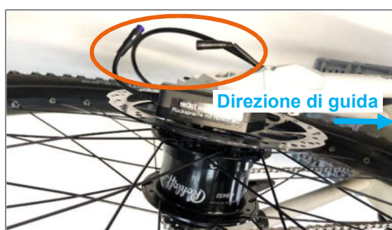
Figura 64: Collegamento a spina allentato (vista dall'alto)
