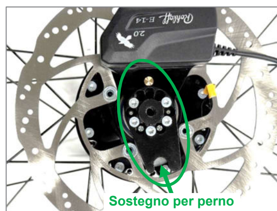
Figura 68: Sostegno coppia con cambio Rohloff sulla ruota motrice (vista dal lato interno ruota)
