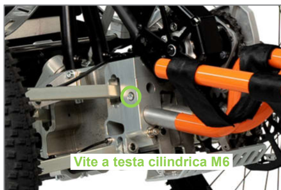
Figura 80: Vite a testa cilindrica M6 sul tunnel di collegamento per la rimozione del supporto per le gambe
