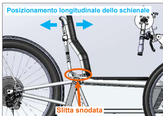
Figura 54: Slitta snodata per il posizionamento longitudinale dello schienale
