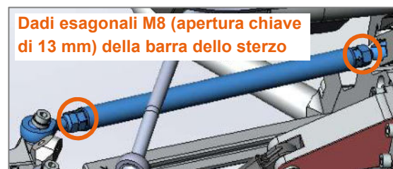
Figura 74: Dadi esagonali M8 sulle barre inferiori dello sterzo a destra e a sinistra
