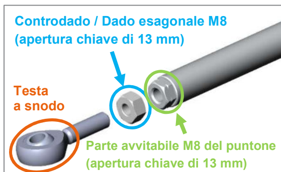
Figura 76: Teste a snodo con parte avvitabile, puntoni e controdadi
