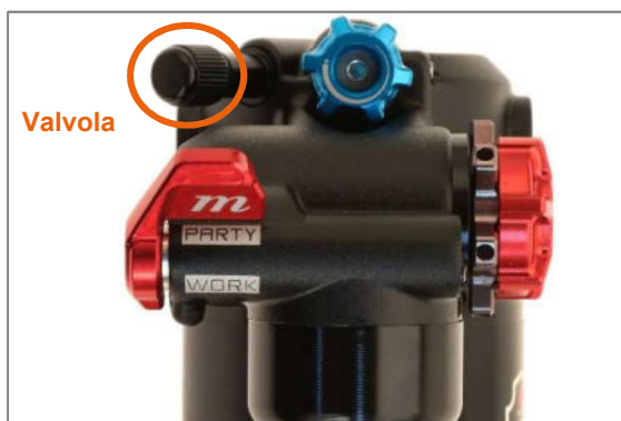
Figura 41: Posizionamento della leva nella "modalità Open/Party" per l'ammortizzatore Manitou Mara Pro
