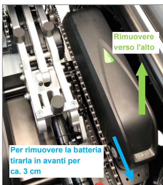
Figura 29: Batteria nei supporti sotto la piastra di seduta
