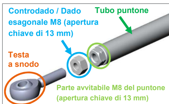
Figura 88: Teste a snodo con parte avvitabile, puntoni e controdati
