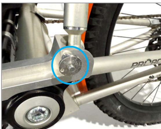
Figura 51: Quick Pin dello schienale sulla slitta snodata (a sinistra)
