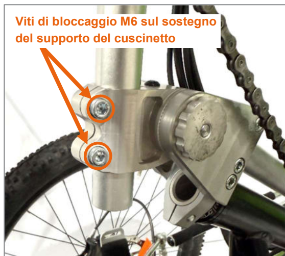
Figura 8: Viti di bloccaggio M6 per la regolazione dell'altezza della posizione del cuscinetto di movimento
