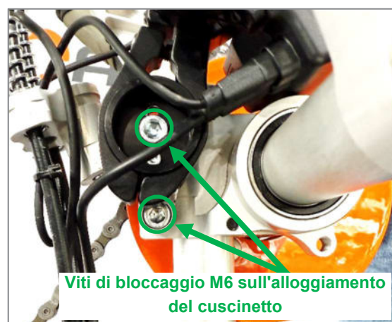
Figura 7: Viti di bloccaggio M6 sull'alloggiamento del cuscinetto
