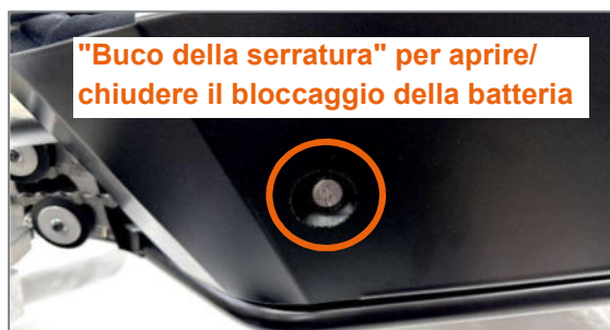
Figura 28: Buco della serratura della batteria accessibile dall'esterno attraverso l'apertura sulla lamiera laterale
