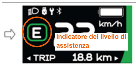
Figura 24: Indicatore con livello di assistenza "E" per Eco (livello di assistenza più basso)
