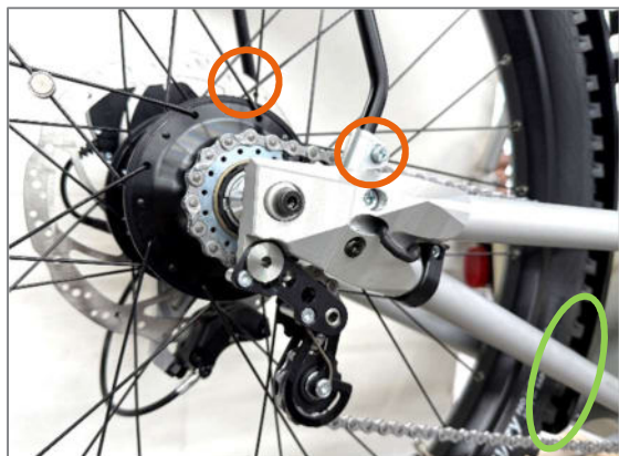
Figura 82: Posizione delle viti a testa cilindrica M5 del fissaggio del parafango
